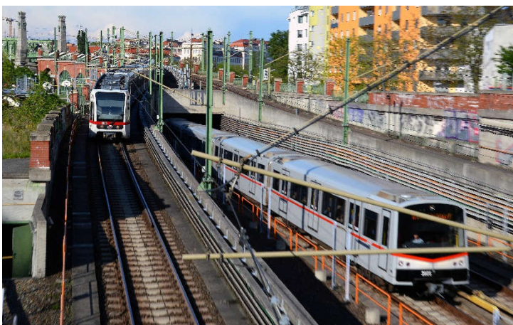
Fotos: R.Fuchs 6.5.2017 Wien: beide Systeme Stadtbahn (Oberleitungsausleger vorne) links, U-Bahn (gelbe Stromschiene) rechts
