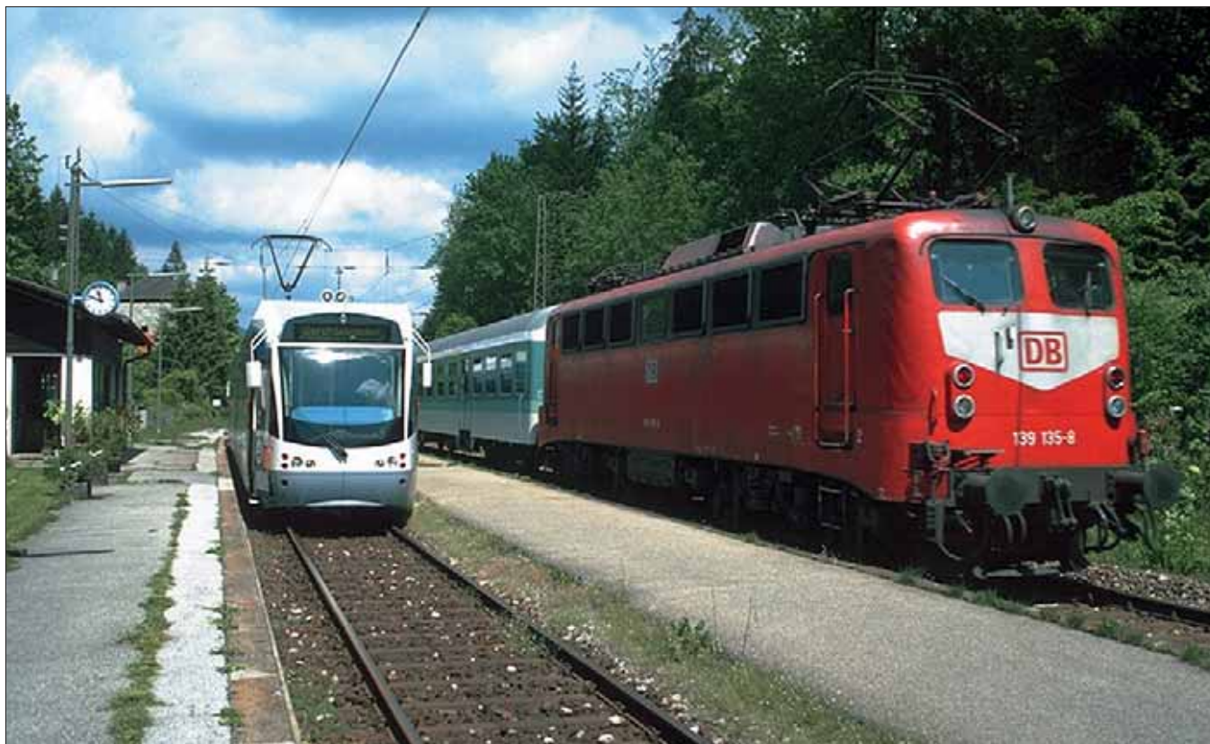
Die bisherige Betriebsabwicklung mit Wendezügen (E-Lok BR 139 und modernisierte "Silberlinge") trifft am Ende der Steilstrecke in Hallthurm die Zukunftsvision "Stadtbahnwagen"
