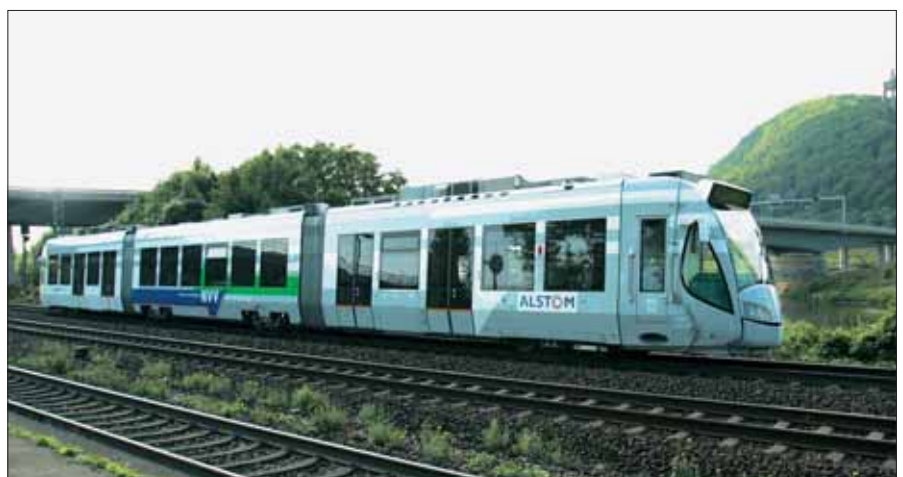
Diesel-RegioCitadis RBK 751 bei der Porta Westfalica. Der Dieseltank befindet sich zwischen den Türen.
