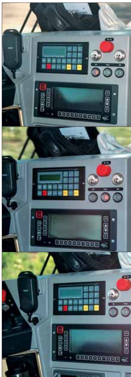
Diese Anzeige zeigt dem Triebfahrzeugführer, welche Spannung die Fahrleitung führt. Beim Durchfahren des Systemwechsels wird im neutralen Abschnitt "Stromlos" angezeigt, ansonsten die jeweilige Spannung 750 V = oder 15 kV 16,7 Hz Fotos (3): R. FUCHS
