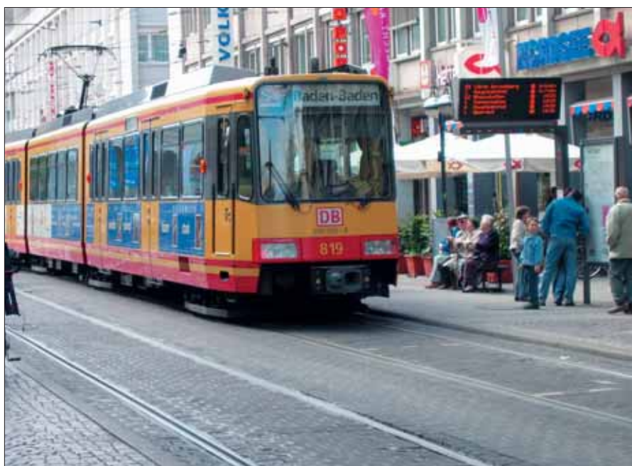
Die DB Regio AG besitzt selbst 4 Zweisystem-Triebwagen. DB-Intern werden die Wagen unter der Baureihe 450 geführt. Wagen 819 der Linie S4 durchfährt auf dem Weg nach Baden-Baden die Karlsruher Fußgängerzone
