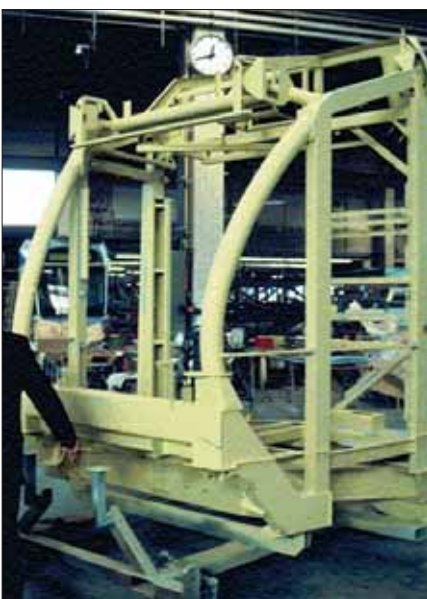
Sicherheitskriterium: Die Endwagen sind mit einem Stahlgerippe ausgestattet, welches einem Pufferdruck von 60 Tonnen standhält Foto: BOMBARDIER
